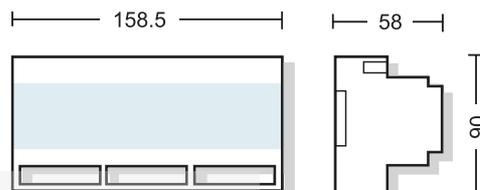
LA UNIKA 4 es una central de control versatil para 4 zonas, puede ser utilizada para la Deteccion de gas, o mixta Deteccion de Gas e Incendio. Su compacta estructura, modular y compatible con la norma DIN EN 50022 ( 9 módulos) permite la instalación en carril DIN.
